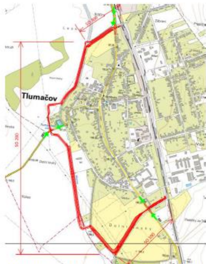
Obr. 5.3.21 Ochranné hráže Tlumačov
