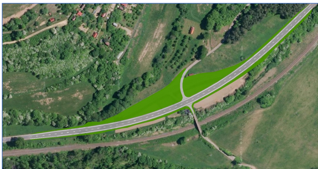
Obrázek 34 Navržená úprava přeložky komunikace
